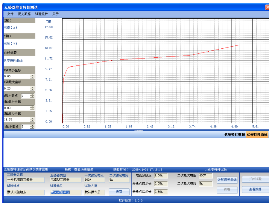
图 6.1.4 PT 伏安特性试验结果显示
