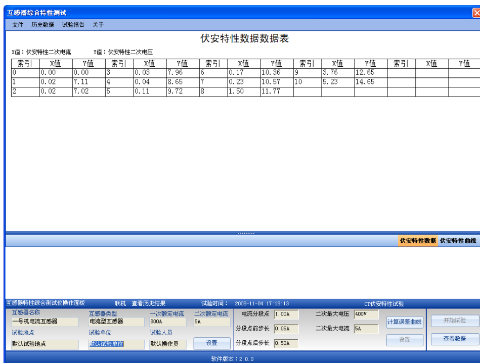
图 6.1.3 CT 伏安特性试验结果显示
