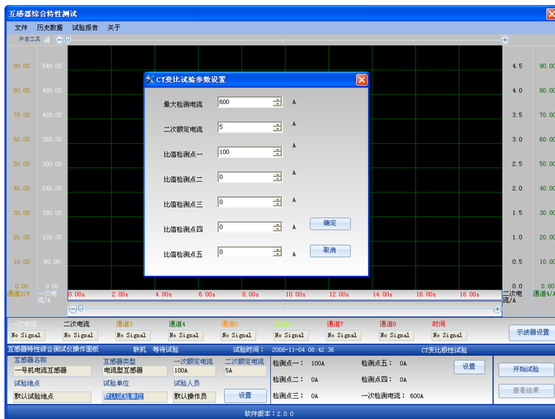
图 6.7 CT 变比极性试验界面
